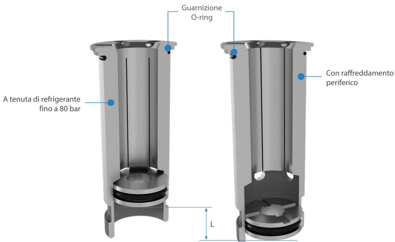
Sfruttando l'arresto regolabile è possibile impostare in maniera flessibile la lunghezza L dell'utensile in tutte le bussole di riduzione.
